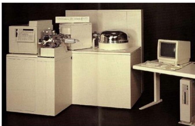
図 3. 初めてコンピューター制御を装備した高分解能質量分析計 MAT90 (1987 年) .
